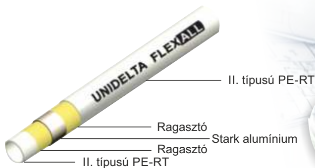
1.1. ábra: A FlexAll ötrétegű cső szerkezete
